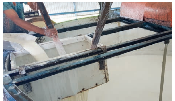
In vielen Weiterverarbeitungsanlagen – wie hier bei der Herstellung von RSS in Indonesien – wird auch das flüssige Latex verwendet, Foto: Dollaris Suhadi
