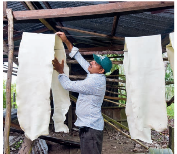
Die aus dem Festkautschuk verarbeiteten Felle werden zum Trocknen im Freien aufgehängt, Foto: Neil Palmer/CIAT/Flickr.com
